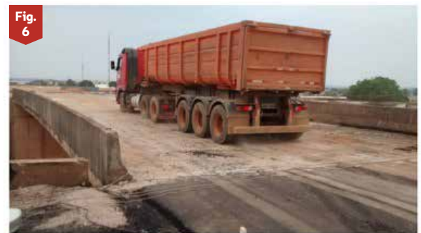
Ensaio de prova de carga em viaduto.
