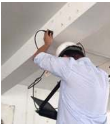
FOTO 01 – Obtenção de resultados de ultrassom em viga
