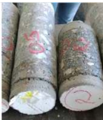
FOTO 02 – Contraprova – extração de testemunho
