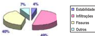
FIGURA 04 Anomalias mais frequentes em paredes exteriores.
