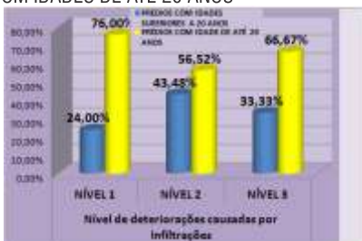
FIGURA 09 : NÍVEL DE DETERIORIZAÇÃO CAUSADO POR INFILTRAÇÕES EM PRÉDIOS COM IDADES SUPERIORES A 20 ANOS E PRÉDIOS COM IDADES DE ATÉ 20 ANOS
